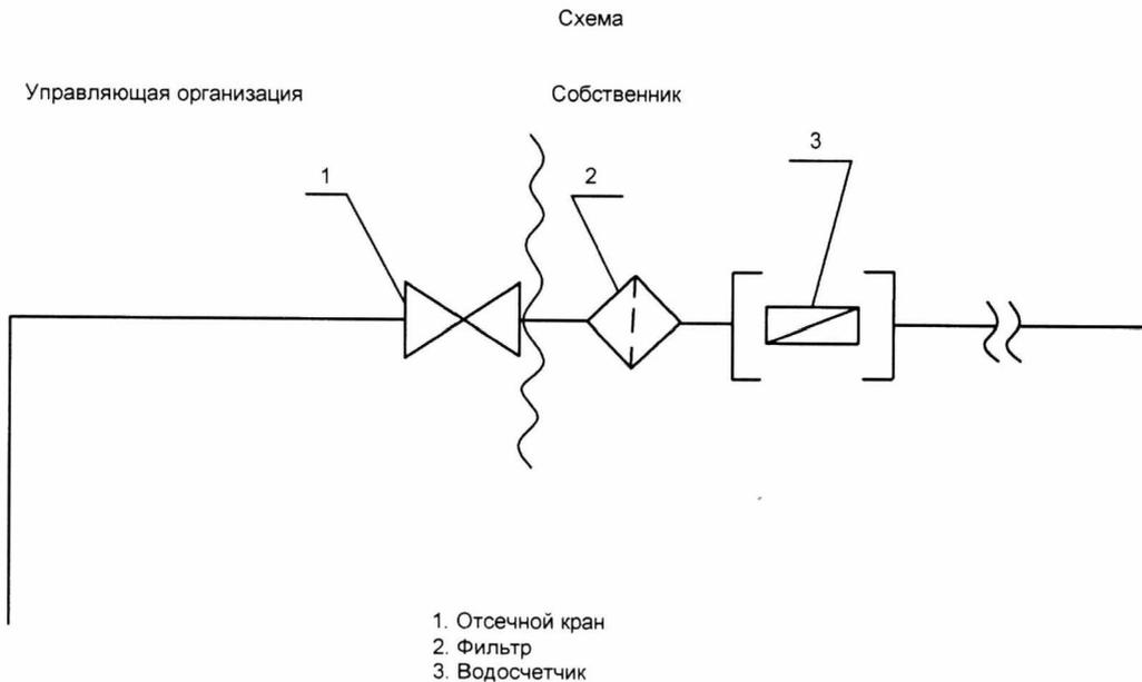
Исполнитель несет ответственность за надлежащее состояние и работоспособность систем горячего и холодного водоснабжения согласно вышеуказанной схеме до волнистой линии слева (включая отсечной кран)
